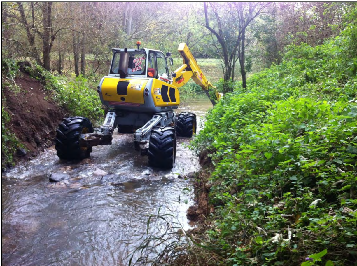
Foto: G. Lehr, Schreitbagger bei der Arbeit kurz oberhalb der Nidda Mündung..
