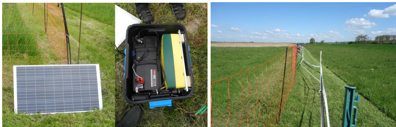
Fotos: links: Weidezaungerät und Solarmodul zur Stromversorgung; rechts: ausgemähte Zauntrasse mit Elektrozaun (orange) und Litzenzaun (weiß) für die Abschreckung von Rehwild (Fotos: Walter Schmidt)
