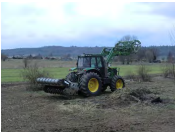
Firma Scherz bei der Bodenbearbeitung mit der Baumstumpfräse
